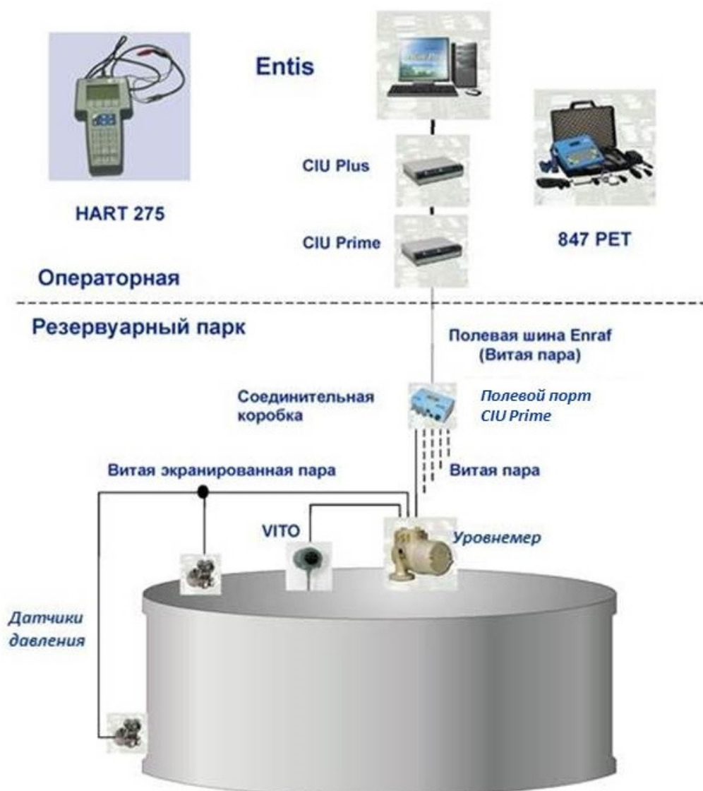
Рисунок 1 – Схема Системы коммерческого учета и контроля резервуарных запасов парка комбинированной установки Entis- т.430-11
