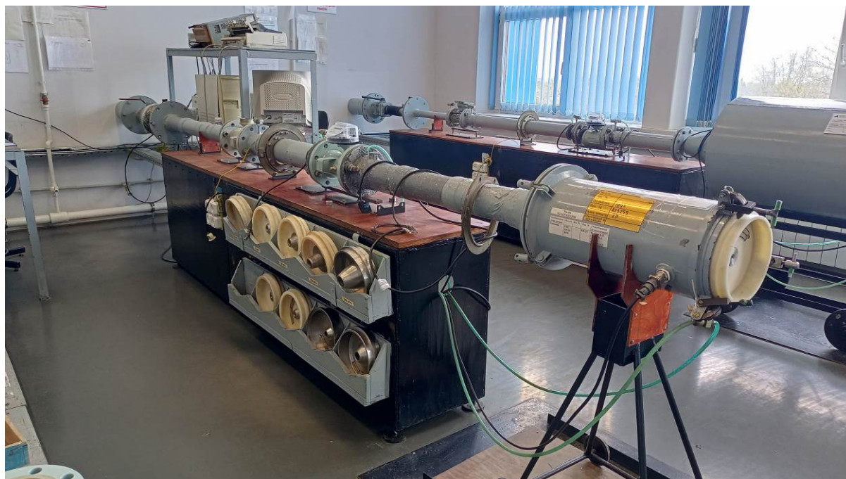
Рисунок 2 – Общий вид установки поверочной расходомерной для счетчиков газа УПСГ-250, заводской № 7
