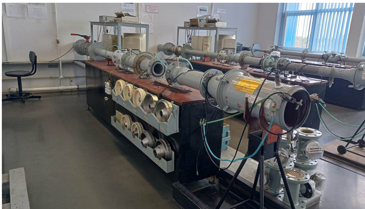
Рисунок 3 – Общий вид установки поверочной расходомерной для счетчиков газа УПСГ-650, заводской № 8
