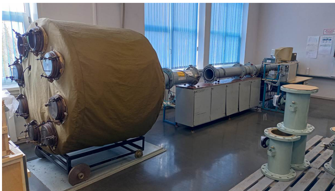
Рисунок 5 – Общий вид установки поверочной расходомерной для счетчиков газа УПСГ-4000, заводской № 4
