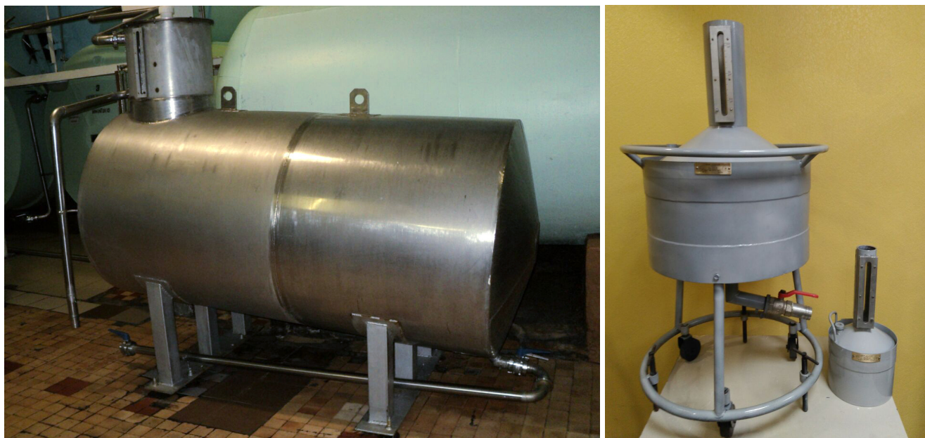
Рисунок 1 - Общий вид мерников металлических технических 1-го класса М1кл Мерники металлические технические 1-го класса М1кл имеют несколько исполнений и маркируются следующим образом:
