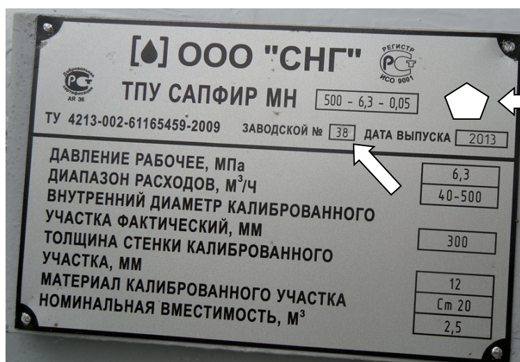
Рисунок 4 – Обозначения мест нанесения знака утверждения типа и заводского номера.
