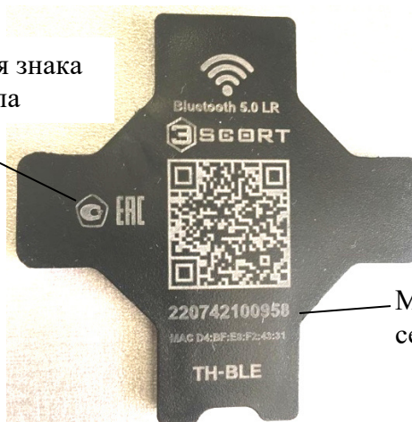
Рисунок 3 – Маркировочная крышка с указанием мест нанесения знака утверждения типа и серийного номера
