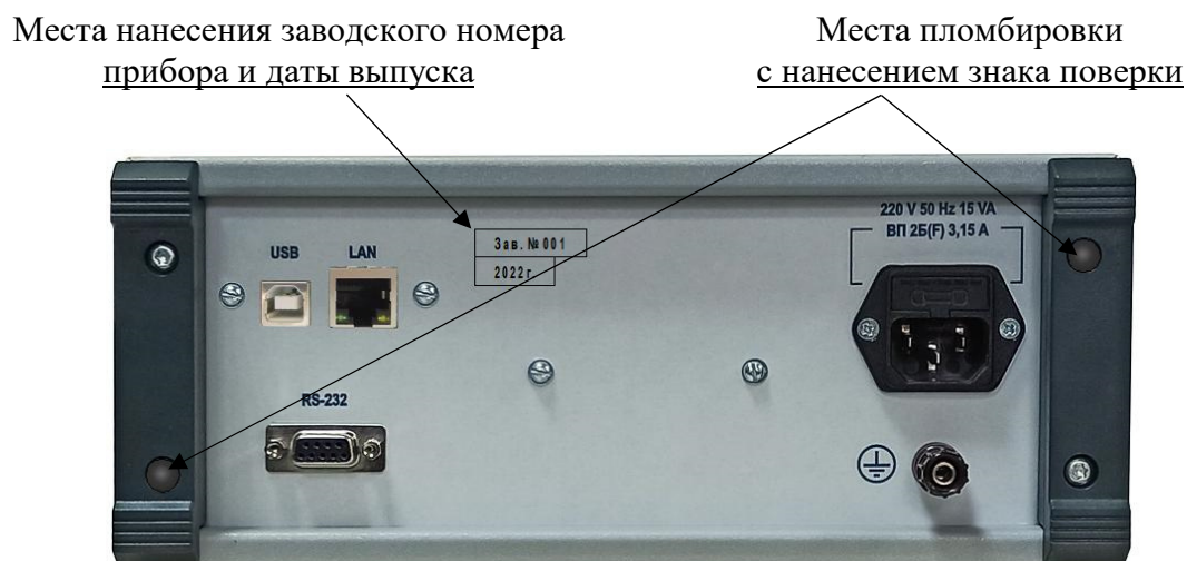
Рисунок 2 – Схема пломбировки от несанкционированного доступа, обозначение мест нанесения знака поверки, заводского номера и даты выпуска.
