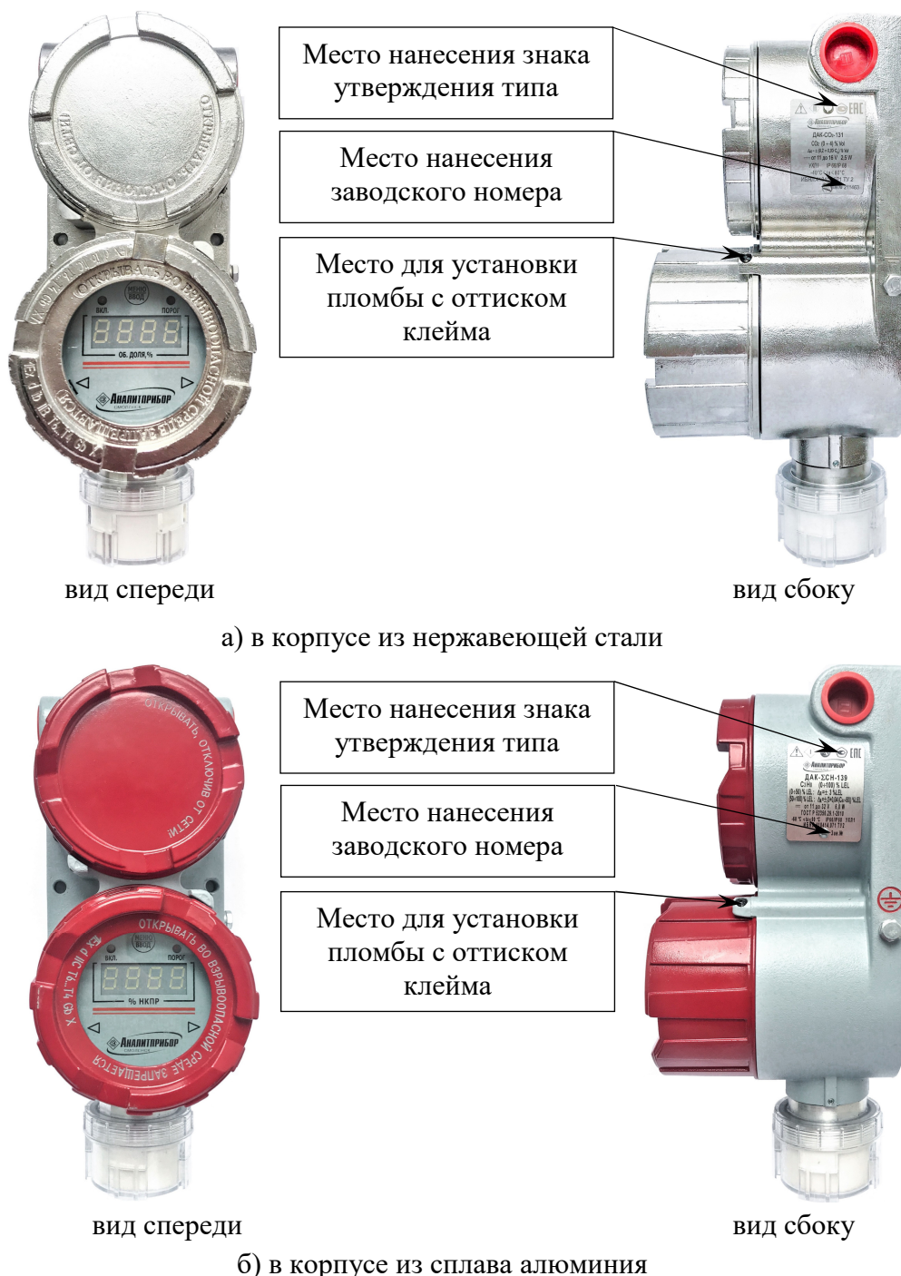
Рисунок 1 – Общий вид газоанализаторов модификаций ИБЯЛ.418414.071-126/-129/-131/-132/-133/-137/-138/-139 с указанием мест пломбировки, нанесения знака утверждения типа, заводского номера
