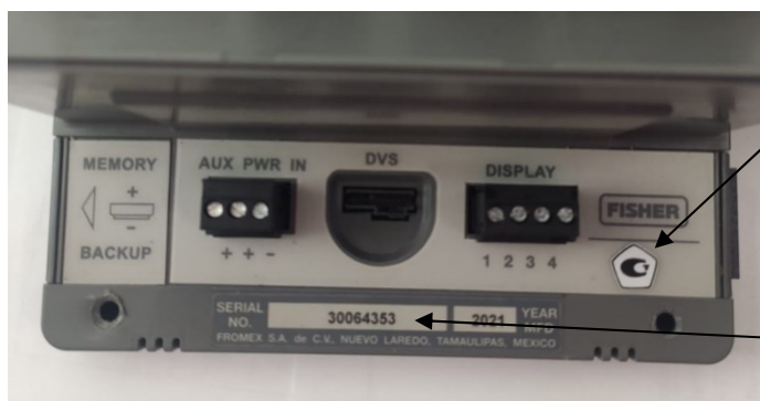
Рисунок 2 – Место нанесения знака утверждения типа и заводского номера
