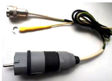
Рисунок 1а – Общий вид пробника Я6-133/1
