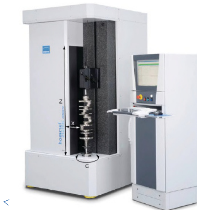
Рисунок 1 – Общий вид системы измерений HOMMEL-ETAMIC CFM3010 с расположением осей измерения
