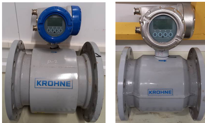
Рисунок 1 – Общий вид расходомеров-счетчиков электромагнитных OPTIFLUX 4300C
