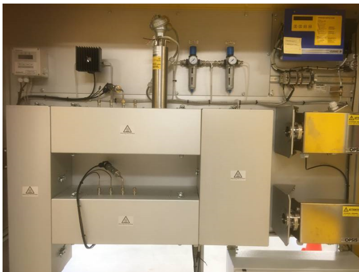
Рисунок 7 - Внутренний вид специализированного шкафа с двумя измерительными кюветами (вторая кювета с конвертером для измерения H_2S или Hg ) и измерителем кислорода
