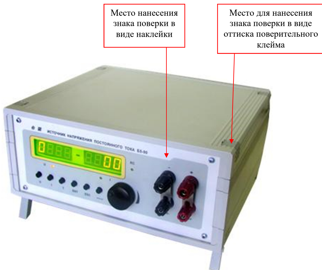
Рисунок 5 – Фотография средства измерений с указанием мест нанесения знаков поверки в виде наклейки и в виде оттиска поверительного клейма нанесенного на мастичную пломбу
