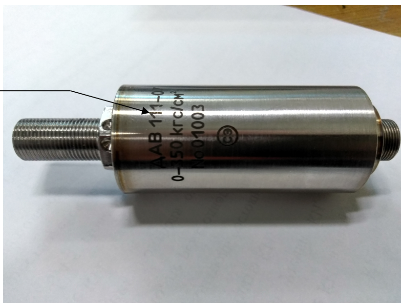
Рисунок 1 – Общий вид датчика ДАВ 111 и место нанесения порядкового номера исполнения датчика, диапазона измерений и заводского номера
