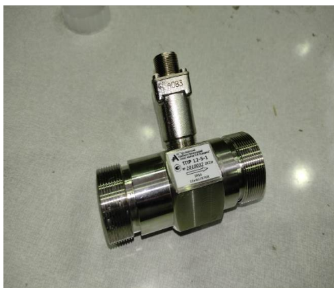
Рисунок 10 – Датчик расхода ТПР12-5-1. Вид общий
