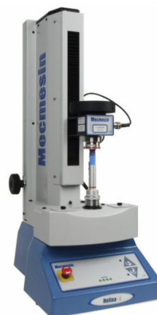
Рисунок 8 – Общий вид измерителей крутящего момента силы Helixa-i
