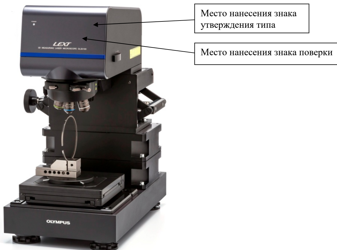
Рисунок 2 - Общий вид микроскопов конфокальных лазерных LEXT OLS5100 модификаций OLS5100-EAF
