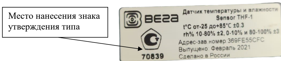
Рисунок 2 – Идентификационная табличка датчиков
