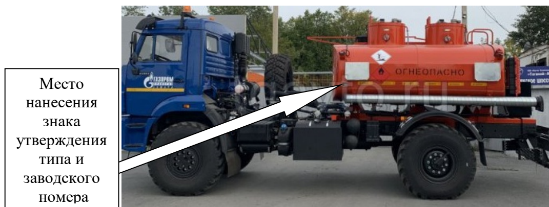
Рисунок 1 – Общий вид АТЗ с двумя секциями
