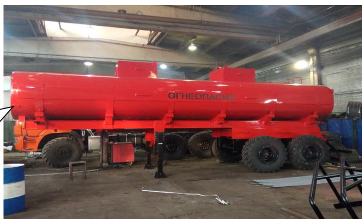
Рисунок 4 – Общий вид ППЦ с двумя секциями
