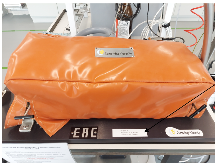
Рисунок 2 – Место нанесения серийного номера на вискозиметры высокого давления VISCOLab PVT
