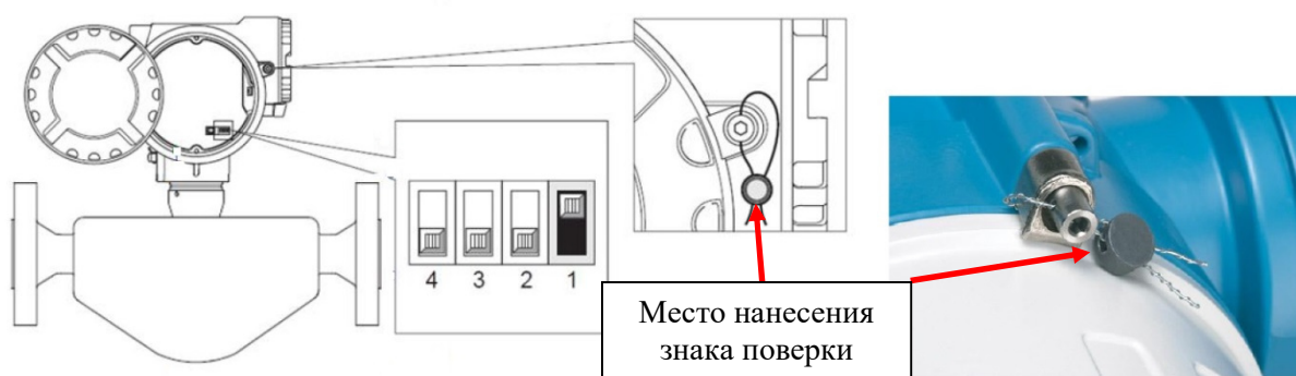
Р и с у н о к 3 – Схема пломбировки расходомера массового LPGmass
