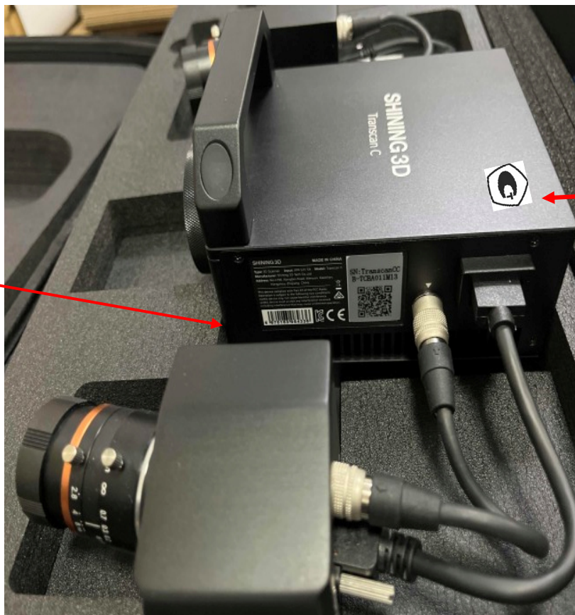
Рисунок 3 - Место расположения маркировочной наклейки с указанием заводского (серийного) номера прибора и место нанесения знака утверждения типа.
