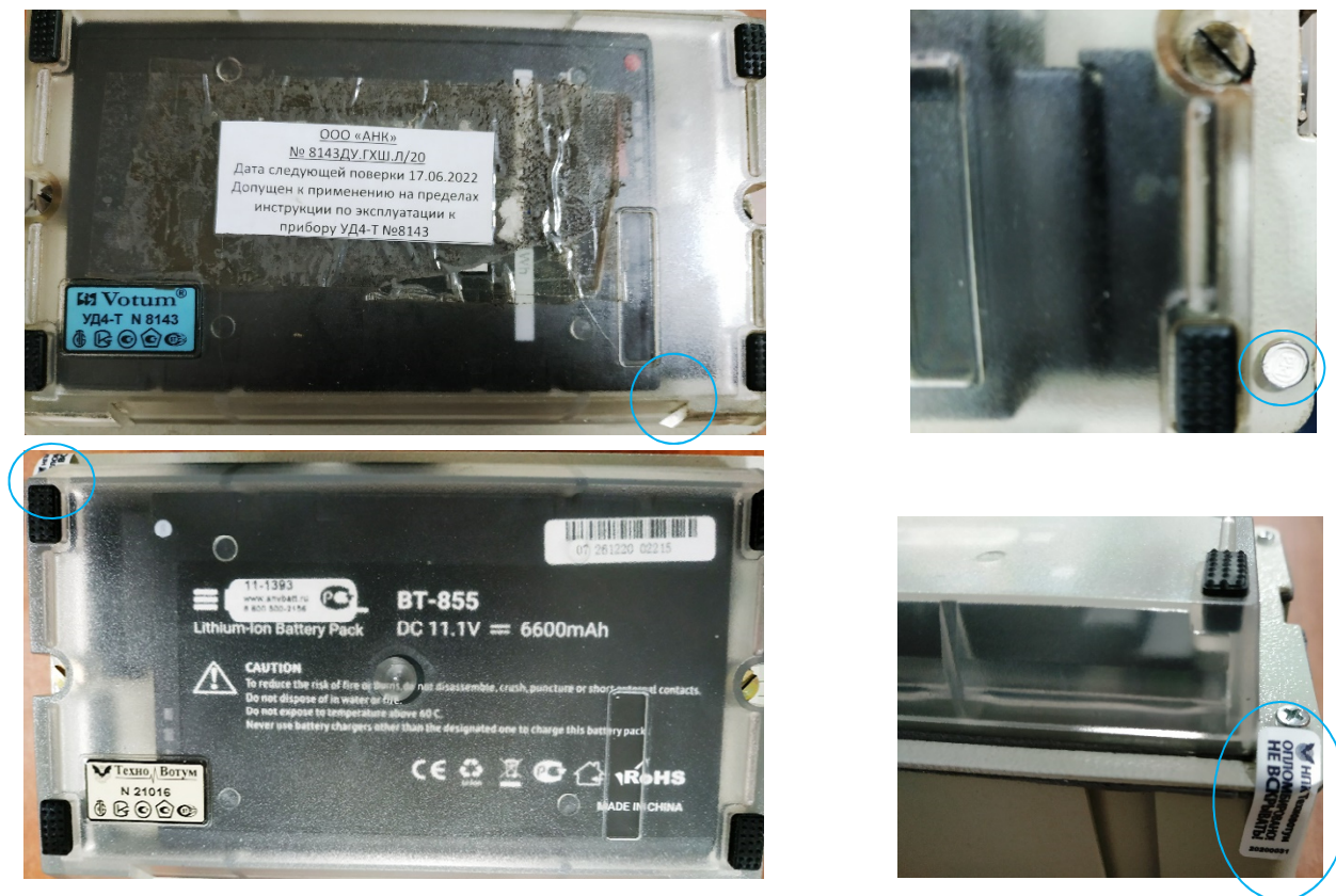
Рисунок 4 – Схема пломбировки от несанкционированного доступа
