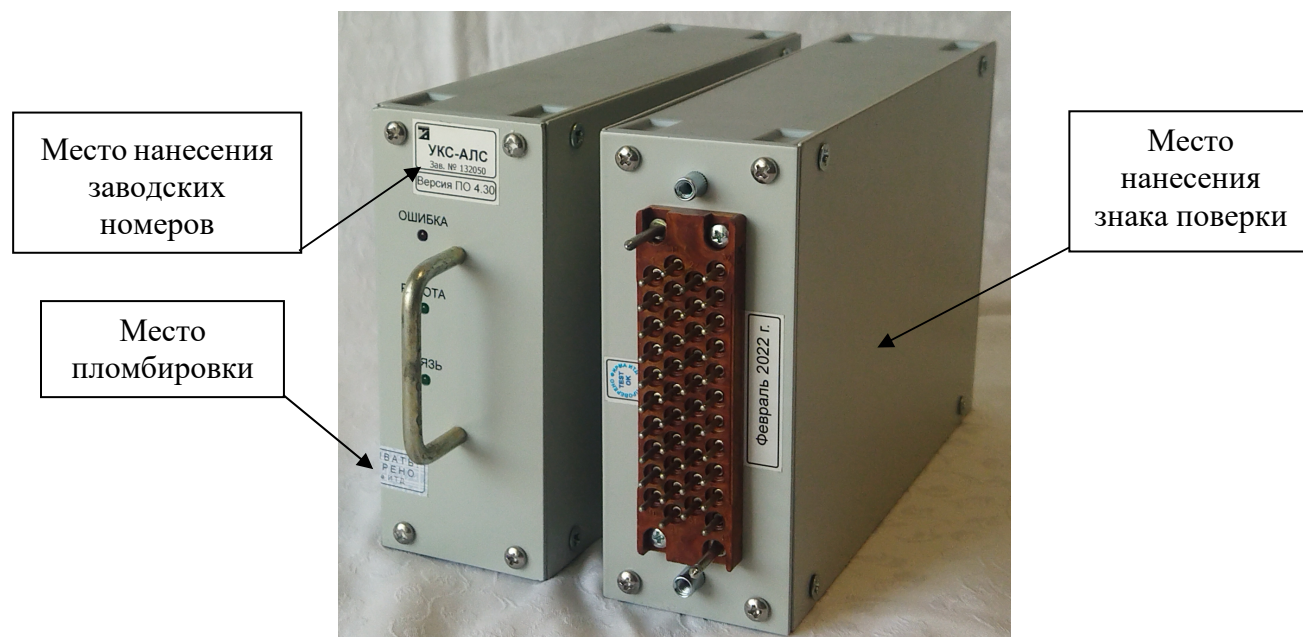
Рисунок 1 – Общий вид устройств УКС-АЛС, мест пломбировки от несанкционированного доступа, обозначение места нанесения знака поверки, место нанесения заводских номеров
