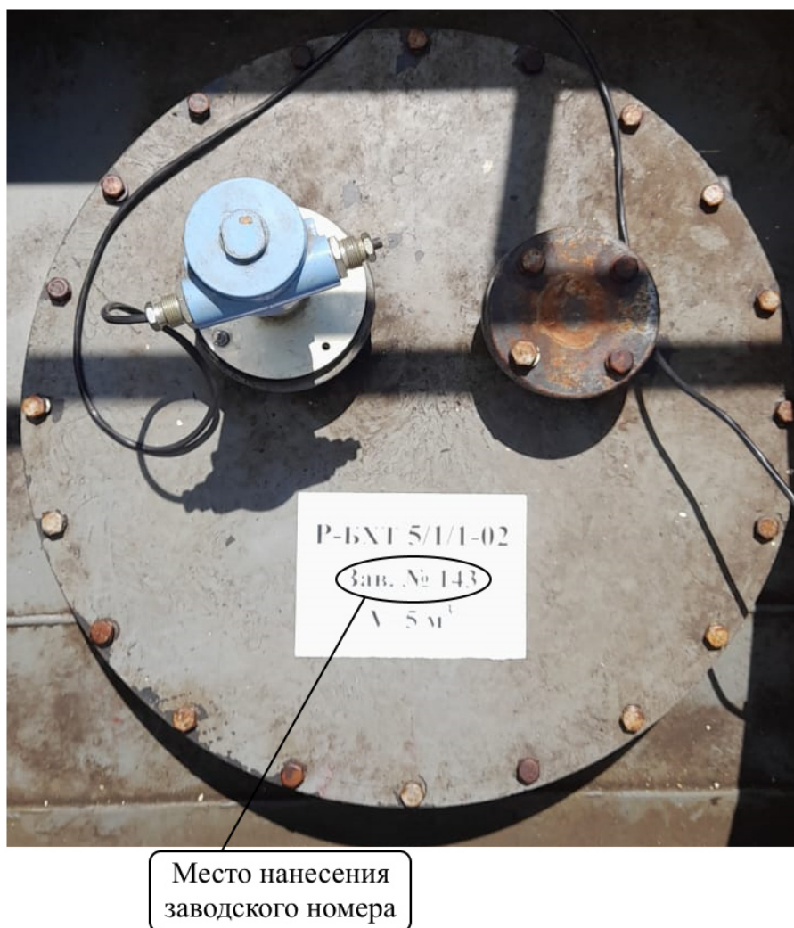
Рисунок 3 – Общий вид резервуара Р-БХТ 5/1/1-02 №143 с указанием места нанесения заводского номера
