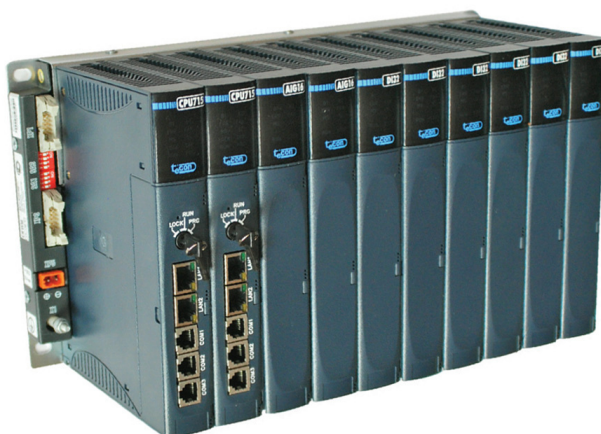
Рисунок 1 – Фотография контроллера МФК1500 с CPU715
