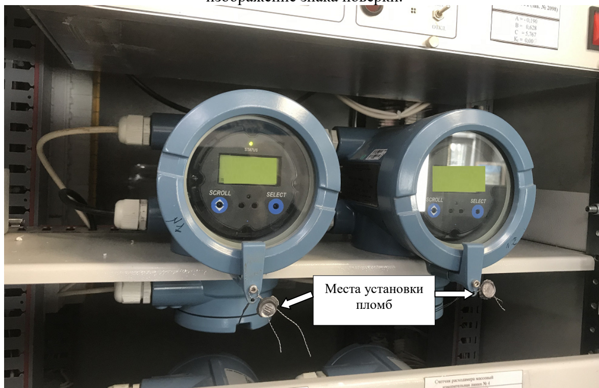
Рисунок 2 – Пример схемы установки пломб, содержащих изображение знака поверки, от несанкционированного доступа на корпусе электронных преобразователей модели 2700 СРМ.
