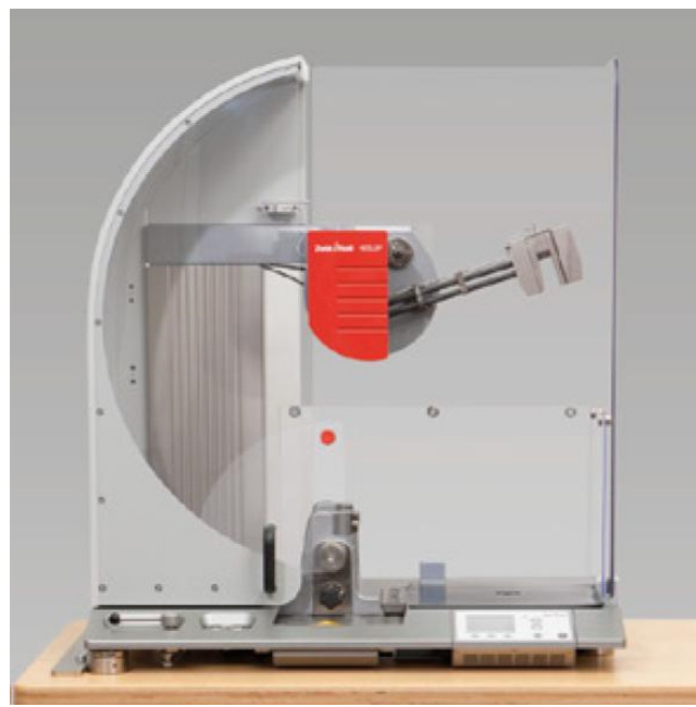
Рисунок 2 – Общий вид копров маятниковых HIT5.5P
