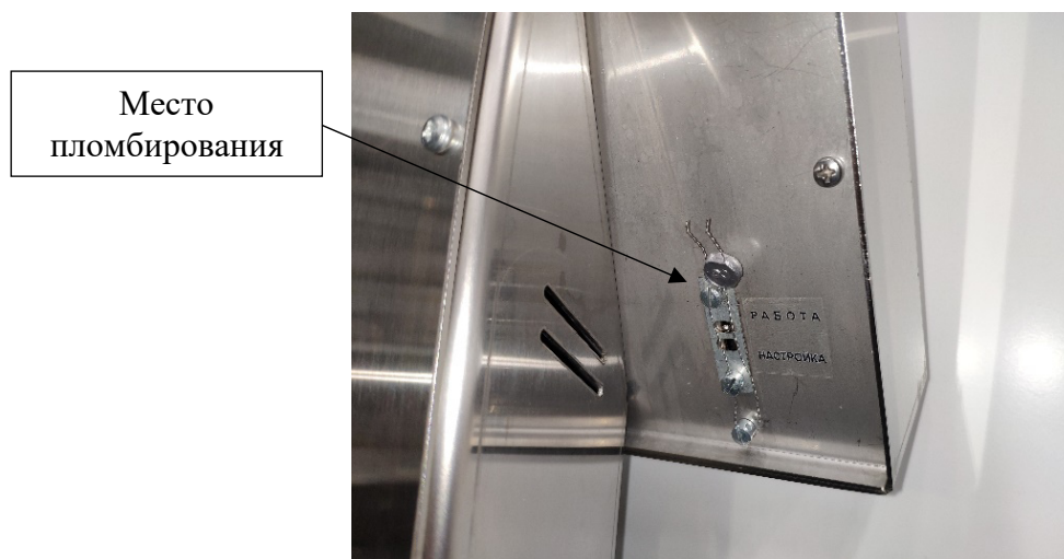
Рисунок 2 – Схема пломбирования от несанкционированного доступа
