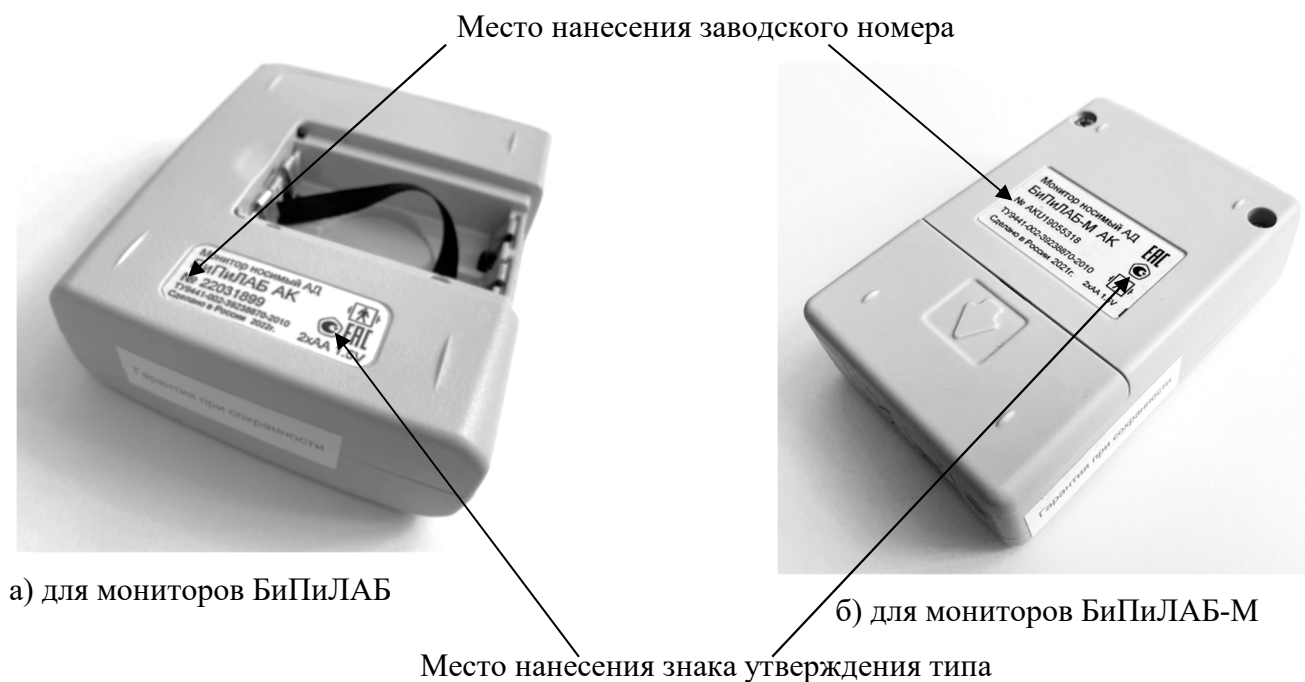
Рисунок 3 – Место нанесения знака утверждения типа и заводского номера на комплексы программно-аппаратные суточного мониторинга АД «БиПиЛАБ»
