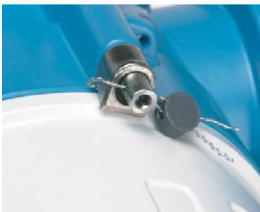
Рисунок 4 – Место нанесения знака поверки на передней крышке расходомера
