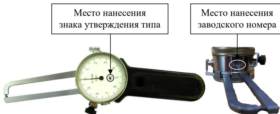
Рисунок 2 – Общий вид стенкомеров С-10Б с указанием мест нанесения заводского номера и знака утверждения типа
