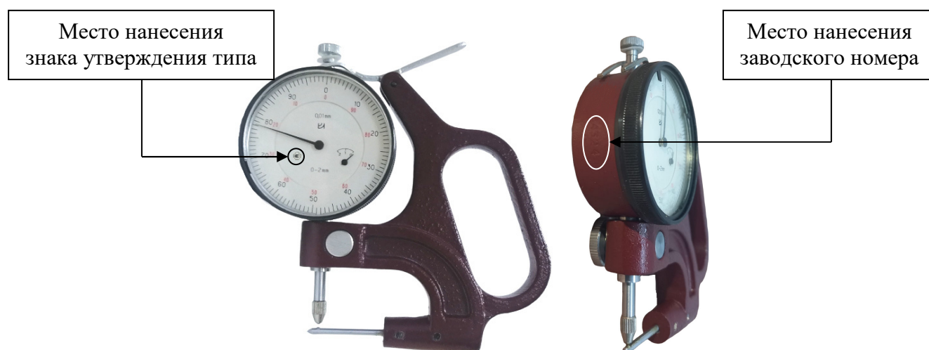
Рисунок 1 – Общий вид стенкомеров С-2, С-10А с указанием мест нанесения заводского номера и знака утверждения типа
