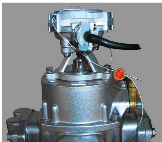
Рисунок 3 - Пломбировка датчика импульсов ДИФВ-2
