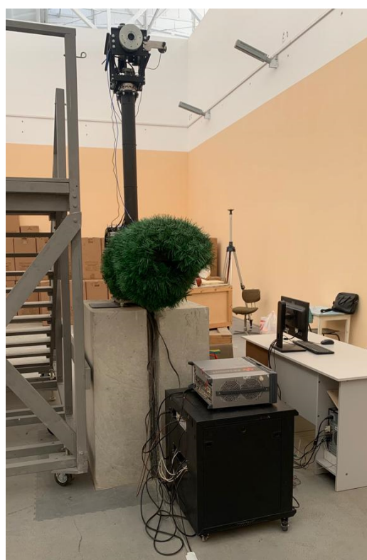
Рисунок 1 – Внешний вид комплекса: прецизионное ОПУ Радант 4К3300-062 (слева) и комплект средств технического оснащения для закрепления вспомогательных антенн (справа)
