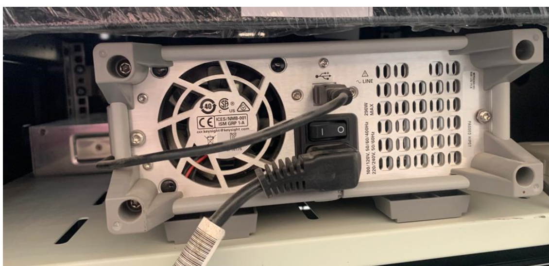
Рисунок 4 – Внешний вид СШП приёмного устройства (цифрового стробоскопического осциллографа) N1094A (виды спереди и сзади)
