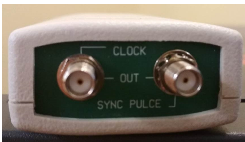
Рисунок 5 – Внешний вид устройства синхронизации СШП-передатчика и СШП-приёмника: общий вид (слева), вид со стороны разъёмов (справа)
