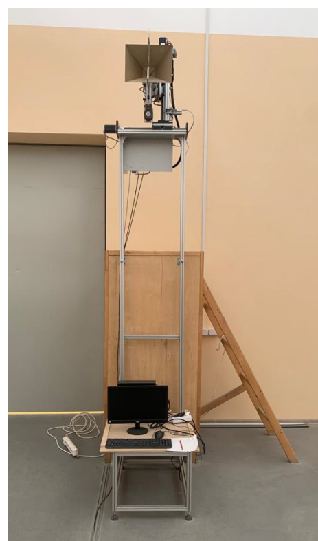
Рисунок 1 – Внешний вид комплекса: прецизионное ОПУ Радант 4К3300-062 (слева) и комплект средств технического оснащения для закрепления вспомогательных антенн (справа)
