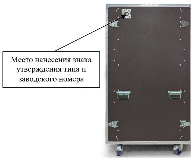
Рисунок 4 – Боковая панель стоек СЭ259, СЭ260, СЭ260-01, СЭ261, СЭ261-01, СЭ262
