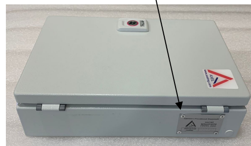
Рисунок 2 – Общий вид измерителей с указанием места нанесения заводского номера
