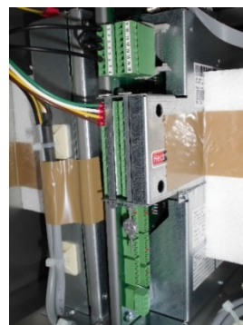
Рисунок 9- Место пломбирования блока питания ER5
