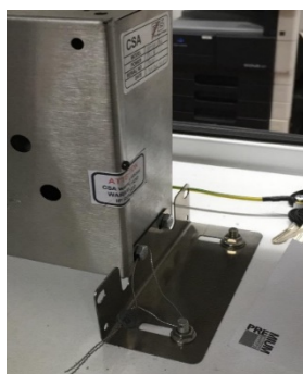
Рисунок 10 - Пломбировка блока CSA
