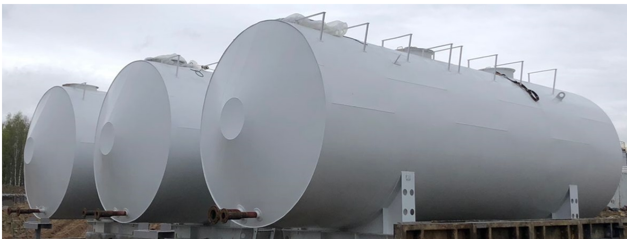
Рисунок 1 – Общий вид резервуаров РГС-75 зав.№№ 20231, 20232, 20233
