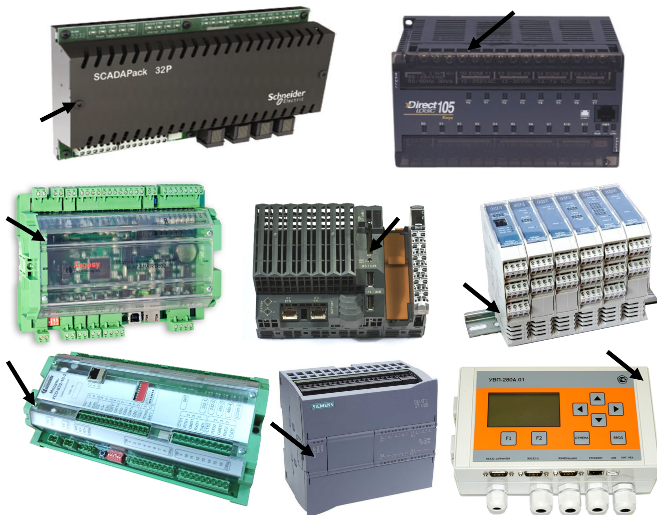
Рисунок 3 - Схема пломбировки от несанкционированного доступа, обозначение нанесения пломб или наклеек
