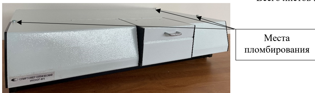
Рисунок 1 - Общий вид спиртомера ИКОНЭТ-М с указанием мест пломбирования
