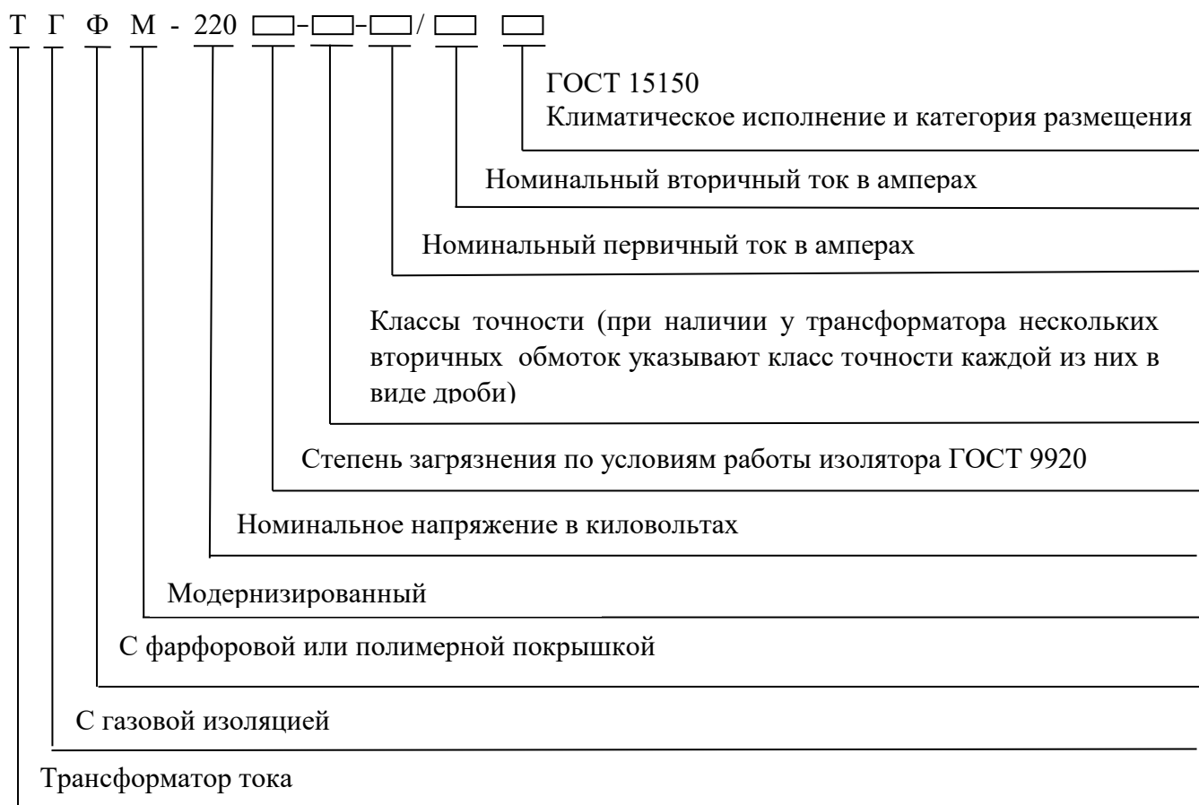
Рисунок 2 – Расшифровка условного обозначения трансформатора
