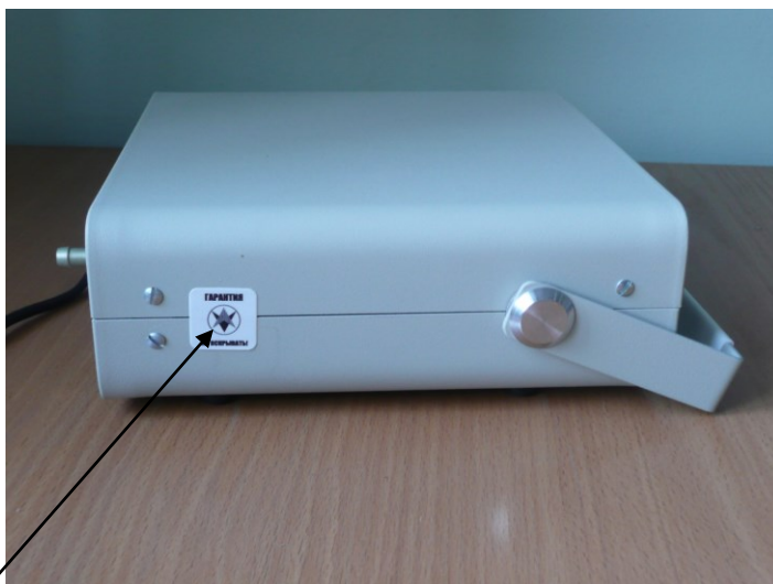
Рисунок 2 – Место нанесения саморазрушающейся наклейки на корпус барометра БРС-1М
