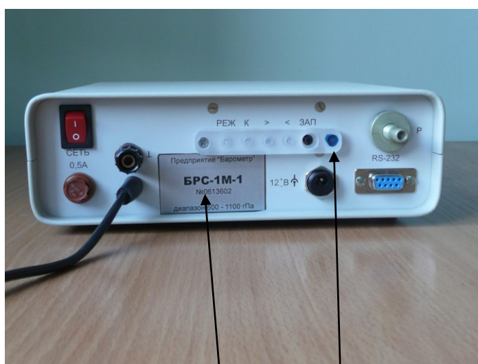
Рисунок 3 – Места нанесения заводского номера и пломбы на крышку кнопок коррекции барометра БРС-1М
