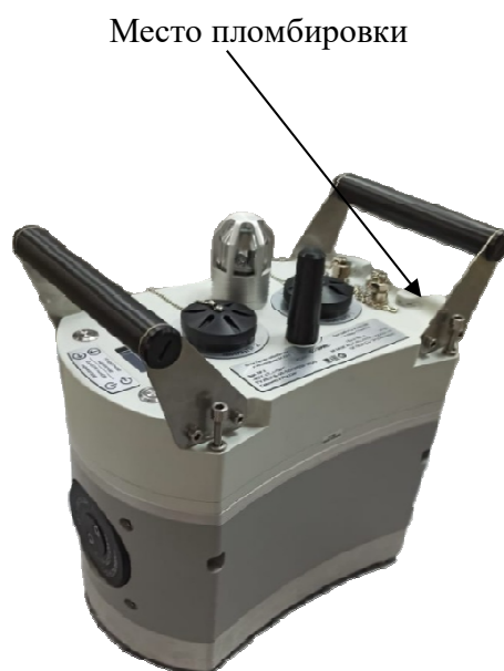
Рисунок 2 – Общий вид газоанализатора ПГ БСОИ и схема пломбировки от несанкционированного доступа
