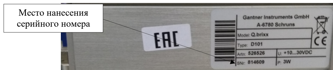
Рисунок 12 – Место нанесения серийного номера на модификации измерительных модулей A103, A104, A105, A106, A107, A108, A111, A116, A146 усилителей измерительных Q.series X (для конструктивных исполнений Q.bloxx и Q.brixx)
