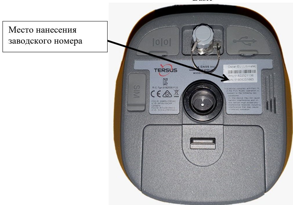
Рисунок 2 – Общий вид аппаратуры геодезической спутниковой Oscar (вид со стороны нижней панели корпуса)
