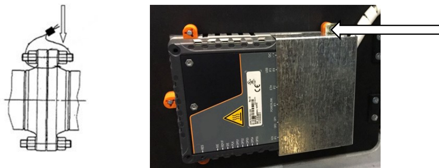
Рисунок 2 – Схема пломбировки от несанкционированного доступа и обозначение мест нанесения знаков на фланцевые соединения средств измерений массы, объема и плотности, и чашечку винта крепления закрывающей пластины контроллера установок
