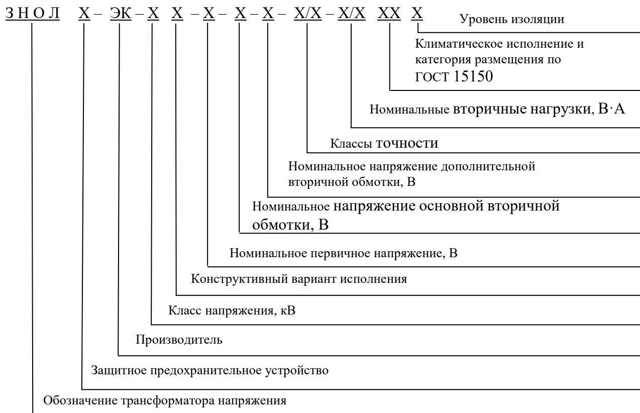
Рисунок 1 – Расшифровка условного обозначения трансформаторов напряжения
