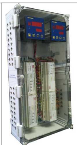
Рисунок 2 – Шкаф измерительный температуры
