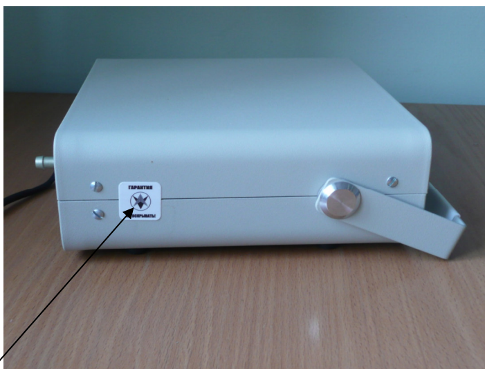
Рисунок 2 – Место нанесения саморазрушающейся наклейки на корпус барометра БРС-1М
