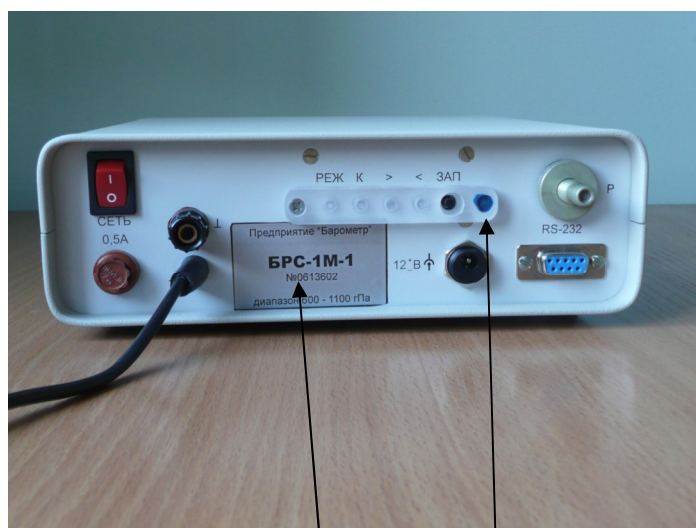
Рисунок 3 – Места нанесения заводского номера и пломбы на крышку кнопок коррекции барометра БРС-1М
