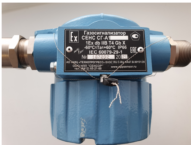
Рисунок 3 – Место для установки пломбы от несанкционированного доступа
