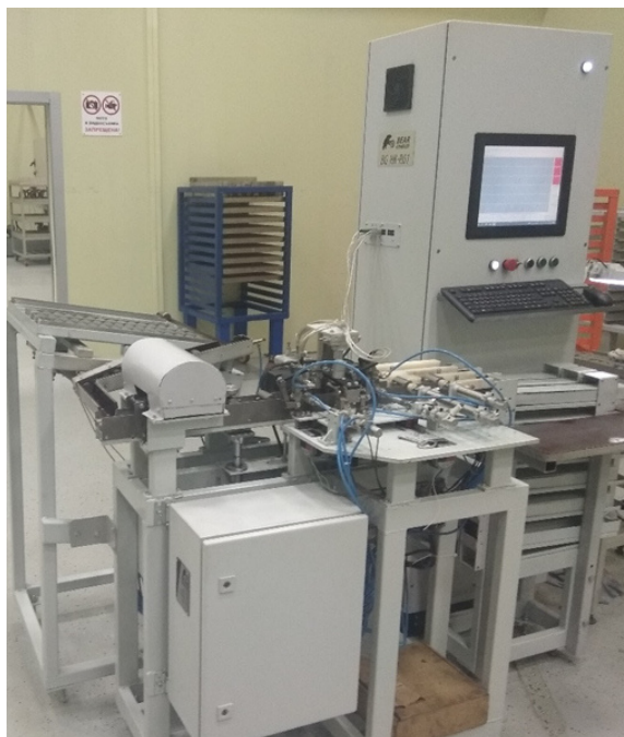
Рисунок 1 – Общий вид автоматов вихретокового контроля роликов BG НК-Р.01
