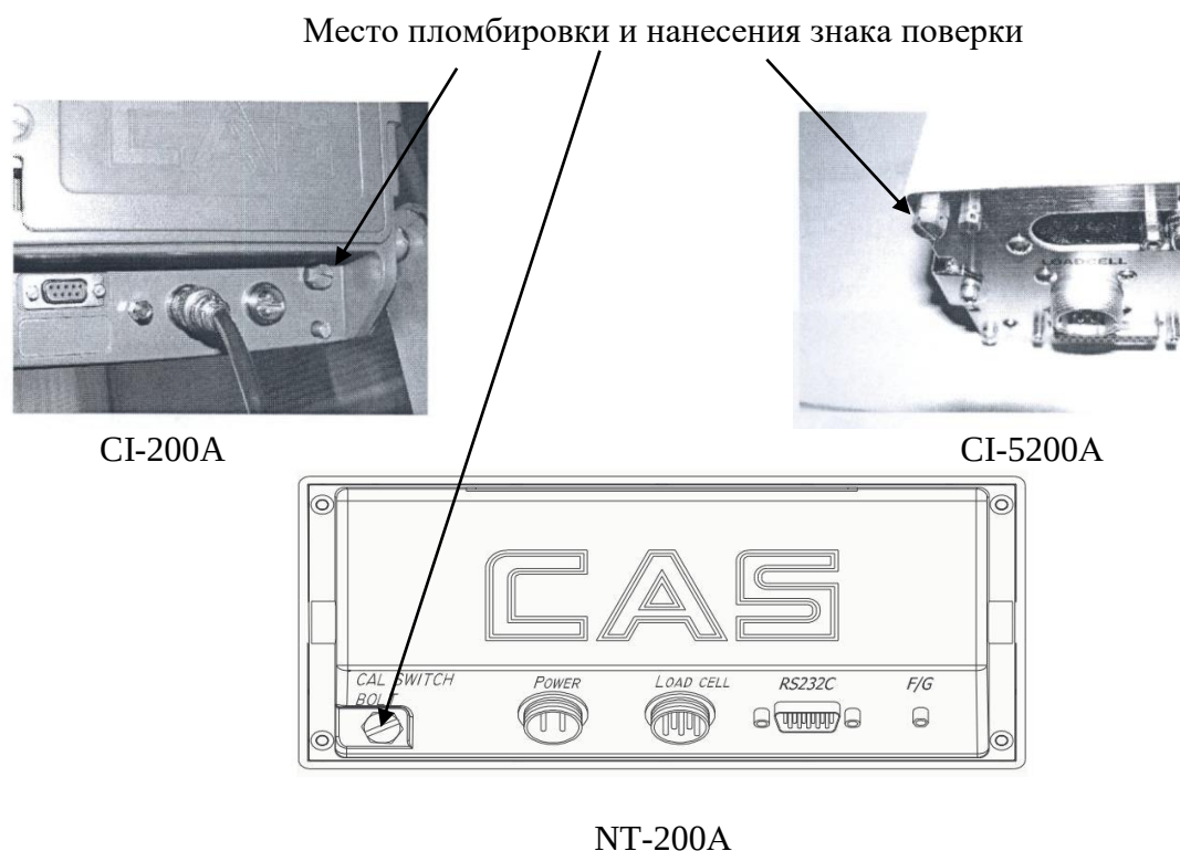
Рисунок 3 - Схема пломбировки от несанкционированного доступа и обозначение места для нанесения отиска клейма на пломбу
