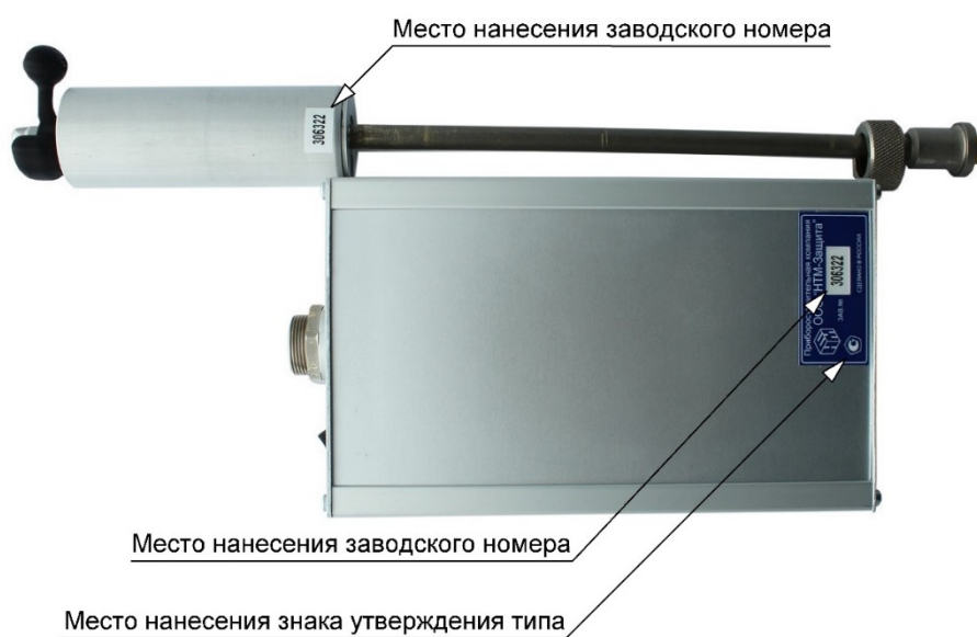
Рисунок 2 – Общий вид измерителя параметров электростатического поля СТ-07 с указанием места нанесения заводского номера блока управления и индикации, первичный преобразователь, а также место нанесения знака утверждения типа.
