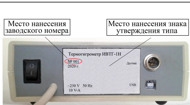
Рисунок 2 - Общий вид термогигрометра настольного исполнения ИВТГ-1Н с указанием мест нанесения знака утверждения типа и заводского номера
