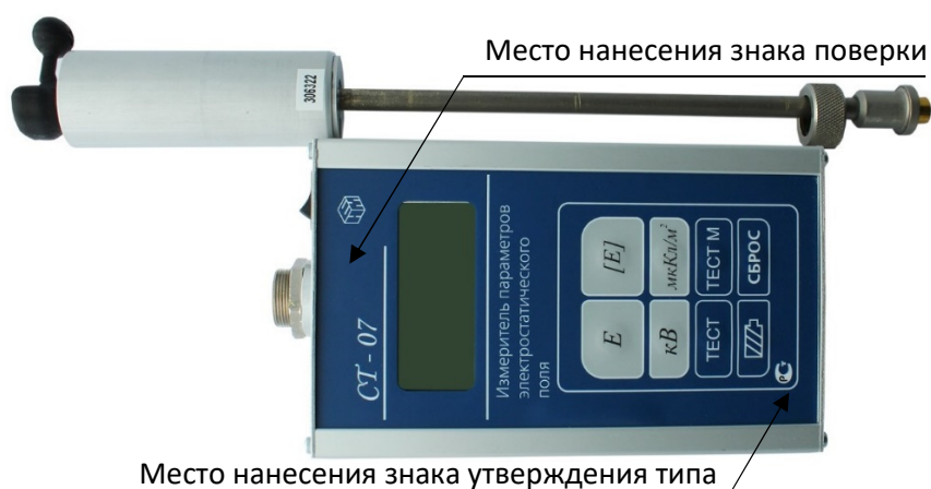
Рисунок 1 – Общий вид измерителя параметров электростатического поля СТ-07 с указанием места нанесения знака утверждения типа и места нанесения знака поверки.
