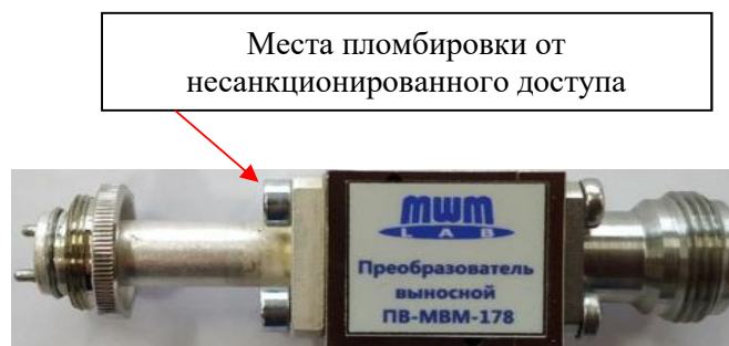
Рисунок 3 – Внешний вид ПВ измерителя с обозначением места пломбировки от несанкционированного доступа
