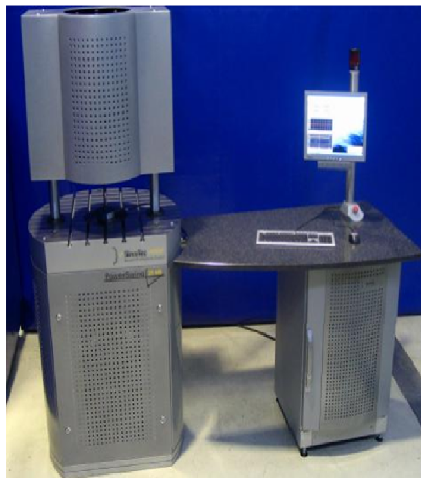
Рисунок 1 - Общий вид машин универсальных для динамических испытаний POWER SWING MAG
