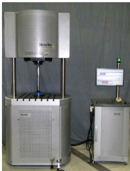
Рисунок 1 - Общий вид машин универсальных для динамических испытаний POWER SWING MAG
