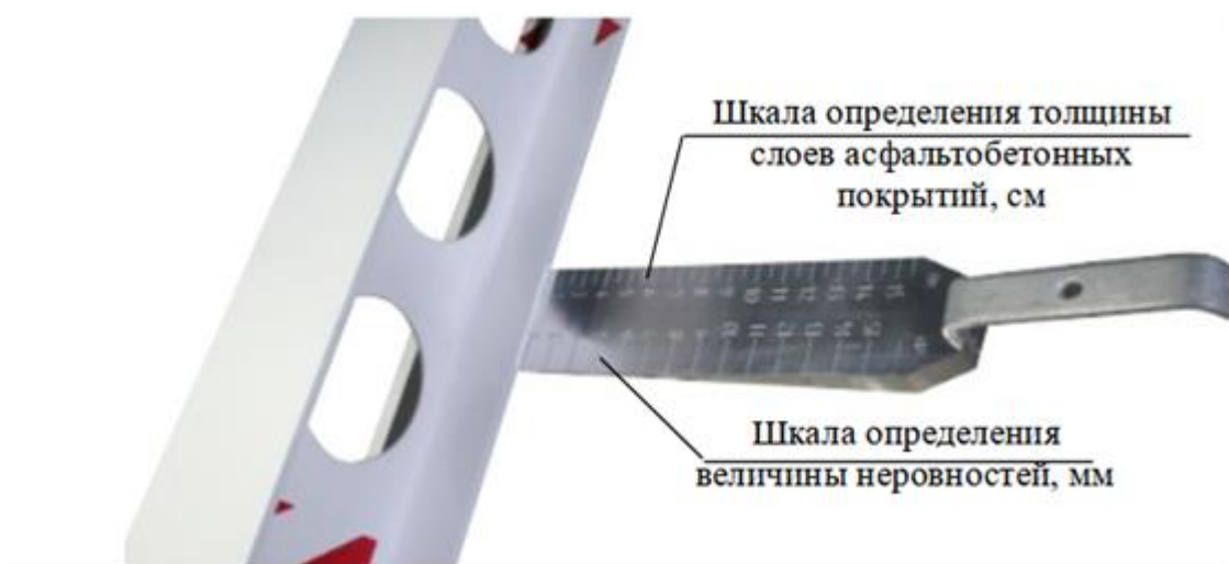
Рисунок 3 – Шкалы промерника клинового
