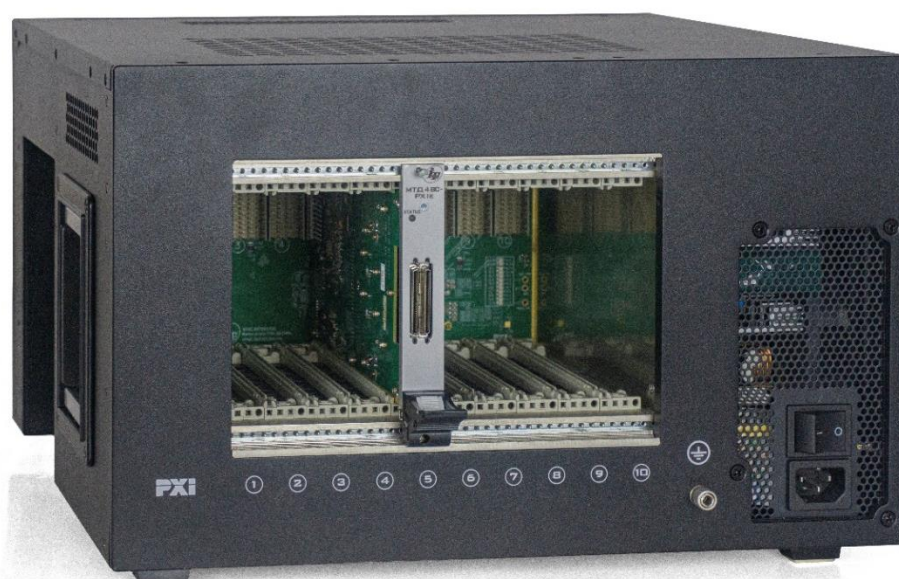
Рисунок 2 – Общий вид измерителей мгновенных значений силы тока МТД48С-PXIe, установленных в моноблок PXIe-10 ФТКС.469133.026
