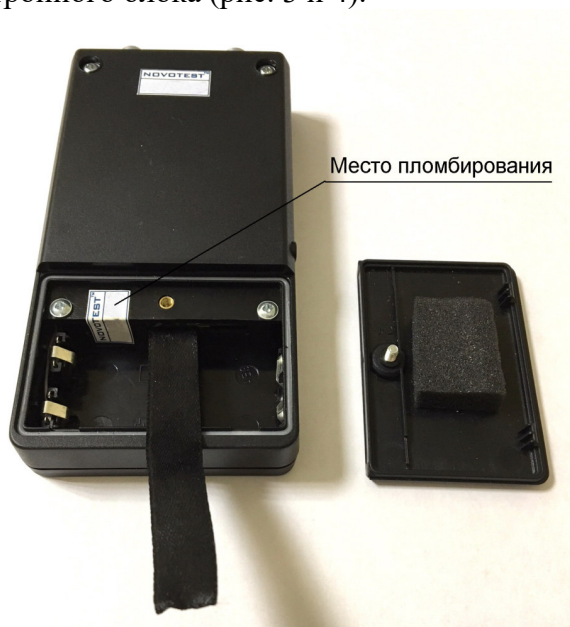
Рисунок 3 - Место пломбирования корпуса прочности строительных материалов NOVOTEST ИПСМ
