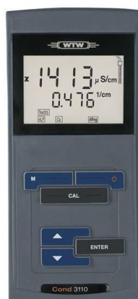
Рисунок 1 – Общий вид измерительного преобразователя кондуктометра Profiline модели Cond 3110.
