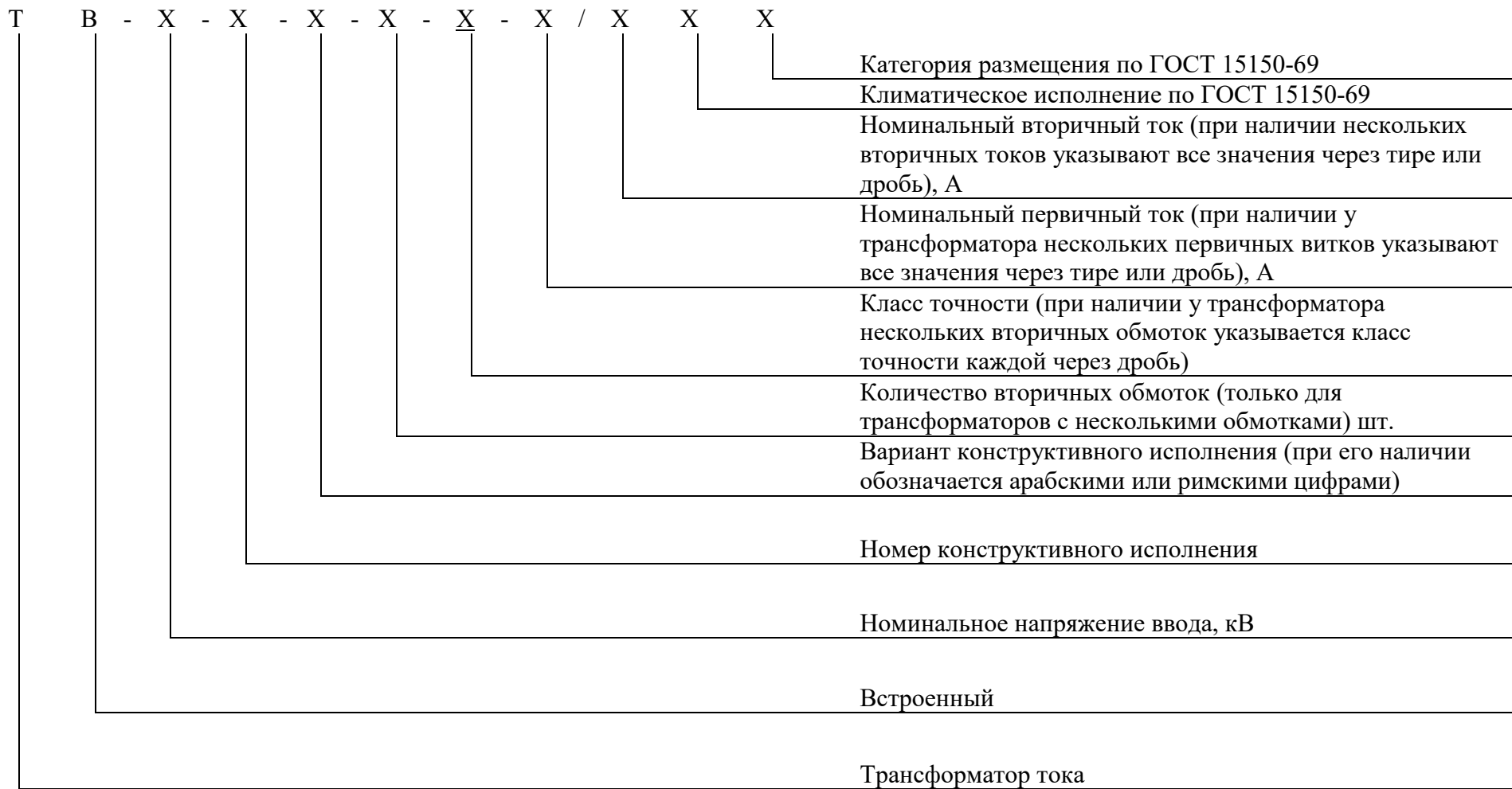
Рисунок 1 – Структура обозначения трансформаторов тока ТВ
