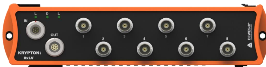
п) модификация KRYPTONi-8xLV с разъемами типа BNC
