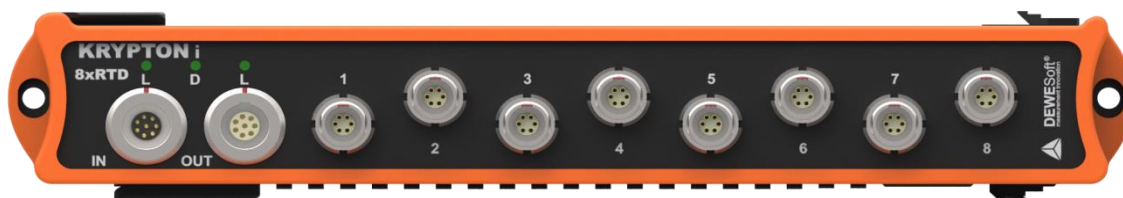
р) модификация KRYPTONi-8xRTD с разъемами типа L0B6f
