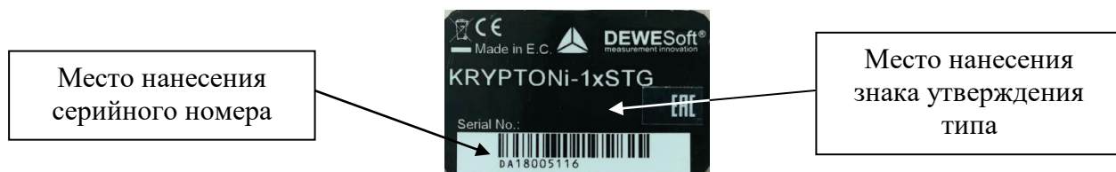
у) маркировочная табличка с указанием места нанесения серийного номера, места нанесения знака утверждения типа
