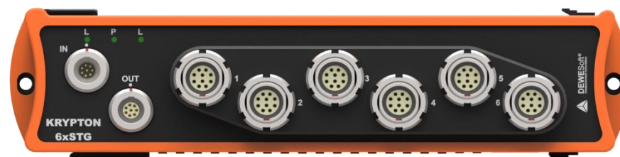
л) модификация KRYPTON-6xSTG с разъемами типа L2B10f
