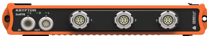
к) модификация KRYPTON-3xSTG с разъемами типа L2B10f
