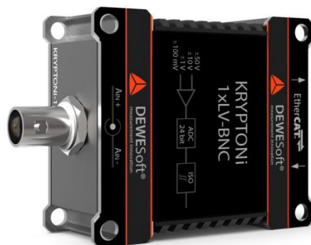
г) модификация KRYPTONi-1xLV-BNC с разъемом типа BNC
