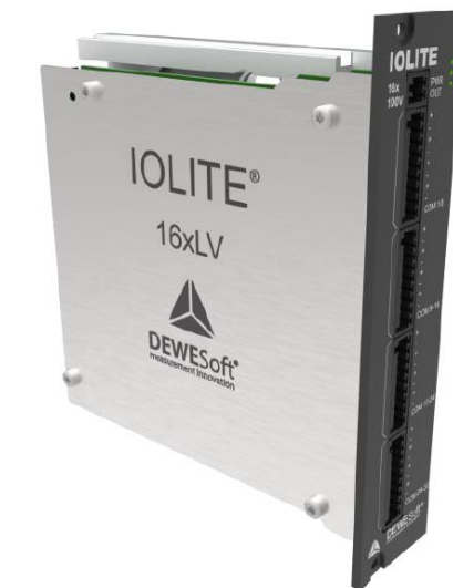
е) модификация IOLITE-16xLV в корпусном исполнении
