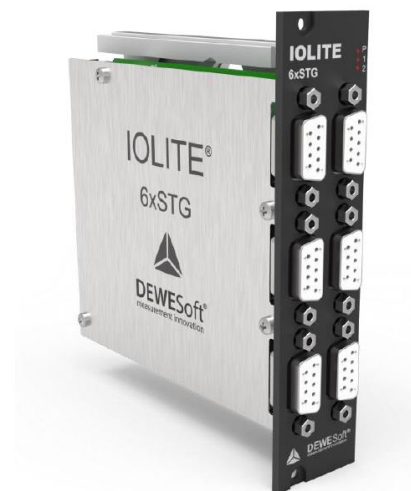
г) модификация IOLITE-6xSTG в корпусном исполнении
