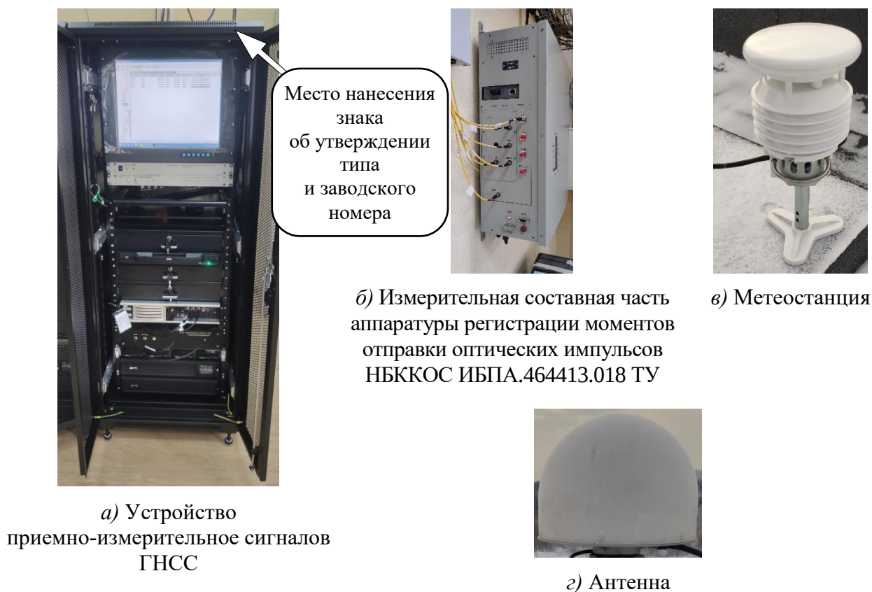
3) Станция измерительная беззапросная опорная ОБИС
