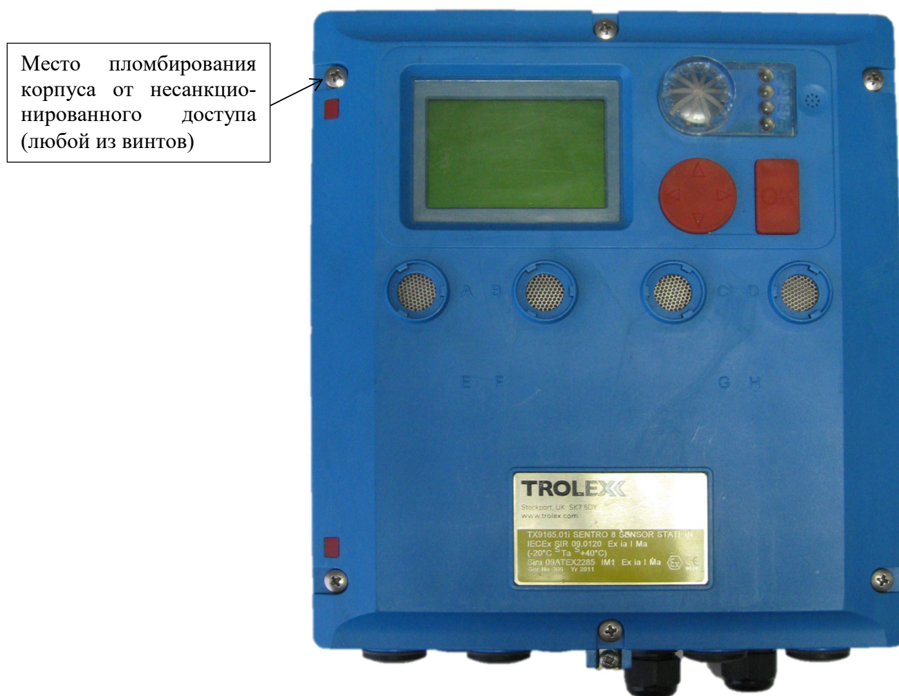
а) SENTRO 8 (на примере исполнения с крышкой для установки 4-х e-Модулей)
